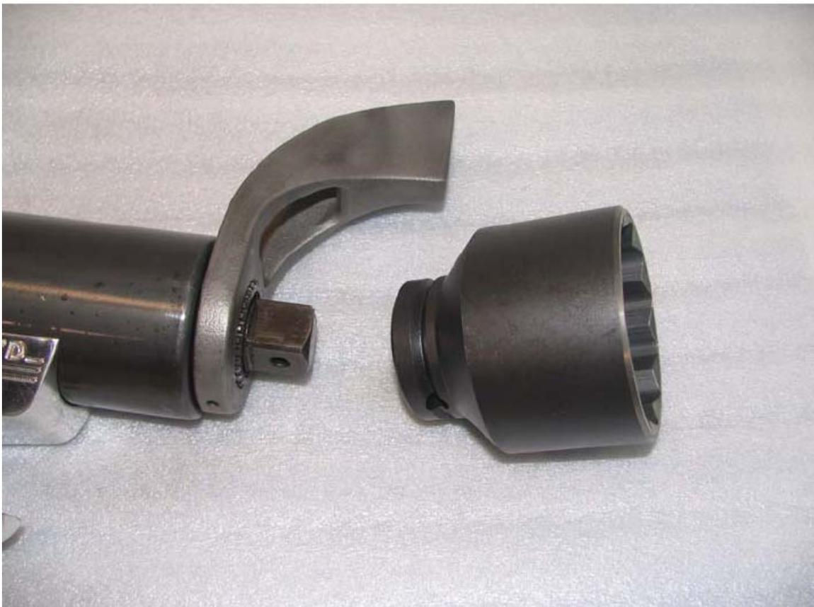
连接时需使用定位销和橡胶保持圈，以保证工作时套筒不会脱落：如下图
