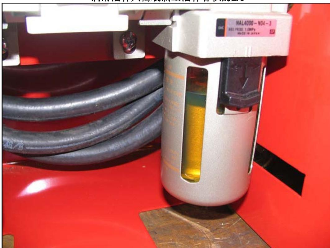
加好润滑油后只需要对准油杯和上部的对位标示再左旋转90°即可装回，注意要卡上黑色卡扣。
